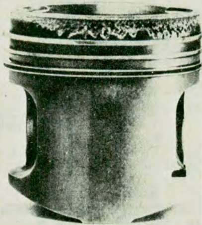
Daños en la parte superior de un pistón con desprendimiento de material a causa de fuertes procesos de detonación.
